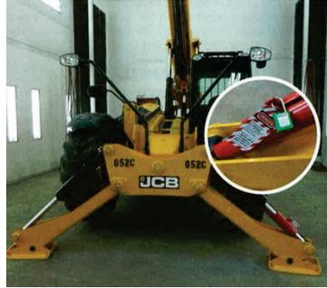
Cadenassage de l'énergie hydraulique et résiduelle d'un équipement mobile en réparation
