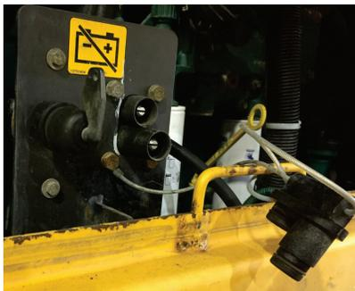
Coupe-batterie cadenassable pour les véhicules-outils ou machines mobiles
