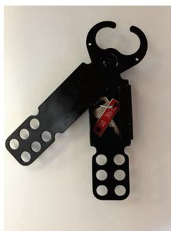
Photo d'une boîte à clé avec un morillon et les cadenas de série excédentaires.
