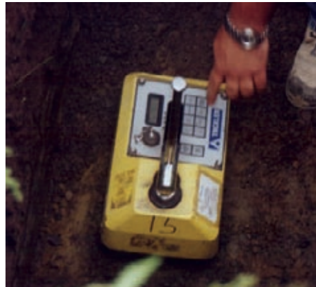
Figure 4 – Mesure de la densité du sol avec un nucléodensimètre
