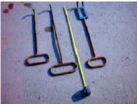
Outils de levage : crochets simple et double
