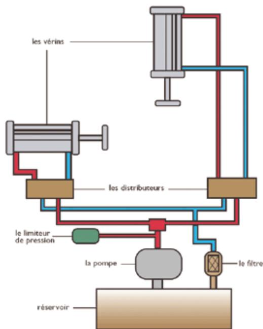
Les composantes du système hydraulique de certains équipements, par exemple celles d'une pelle mécanique, sont beaucoup plus nombreuses et le circuit plus complexe, mais le principe demeure le même. Le fluide
