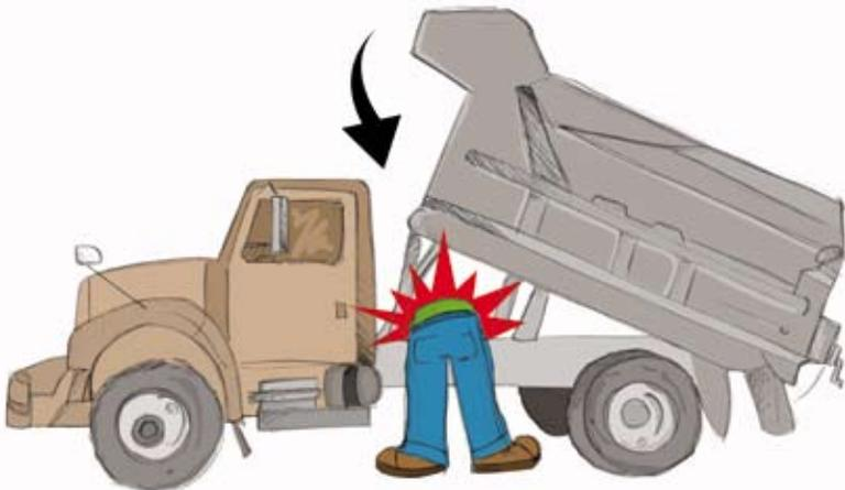
Au même moment, sans avoir décelé sa présence, le mécanicien abaisse la benne. Le chauffeur se fait écraser sous la benne.
