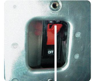
L'interrupteur du module de batteries
