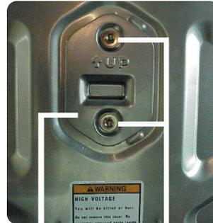
Couvercle de l'interrupteur du module de batteries Boulons
