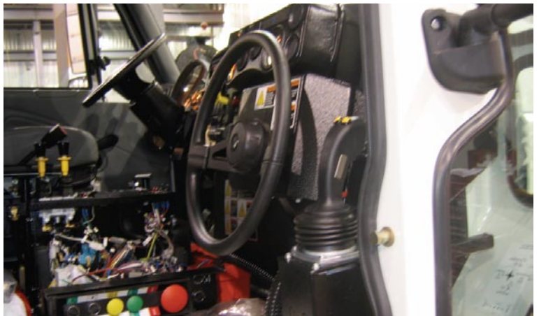
PHOTO 1 MANETTE DE COMMANDE AJUSTABLE ET VOLANT INCLINÉ À 15°
