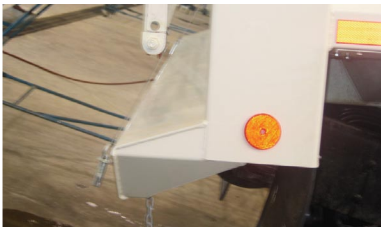
PHOTO 5 PARE-CHOC ARRIÈRE À 45°
