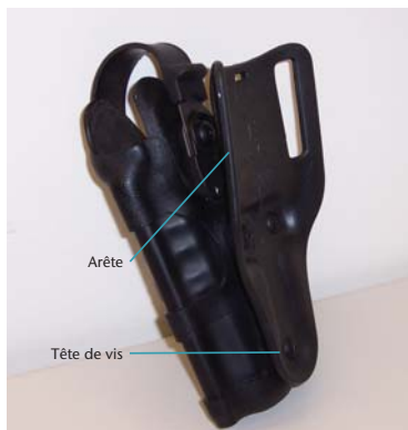
Exemple de défauts de conception d'un étui de pistolet occasionnant des douleurs
