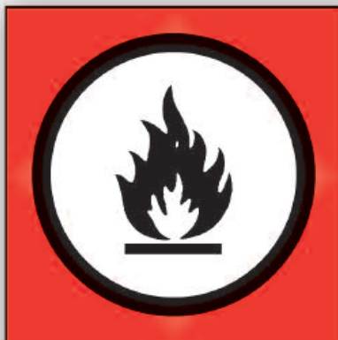
Matières inflammables et combustibles
